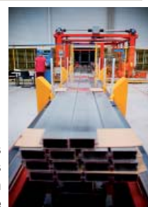
4. Entrée des profilés dans magasin automatique
